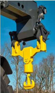
N.C. Nielsen har utvecklat en Quickshift-lösning för reachstackers i kategorin 85 till 110 ton, som gör det möjligt att byta mellan krok och containerok på cirka 15 minuter.
